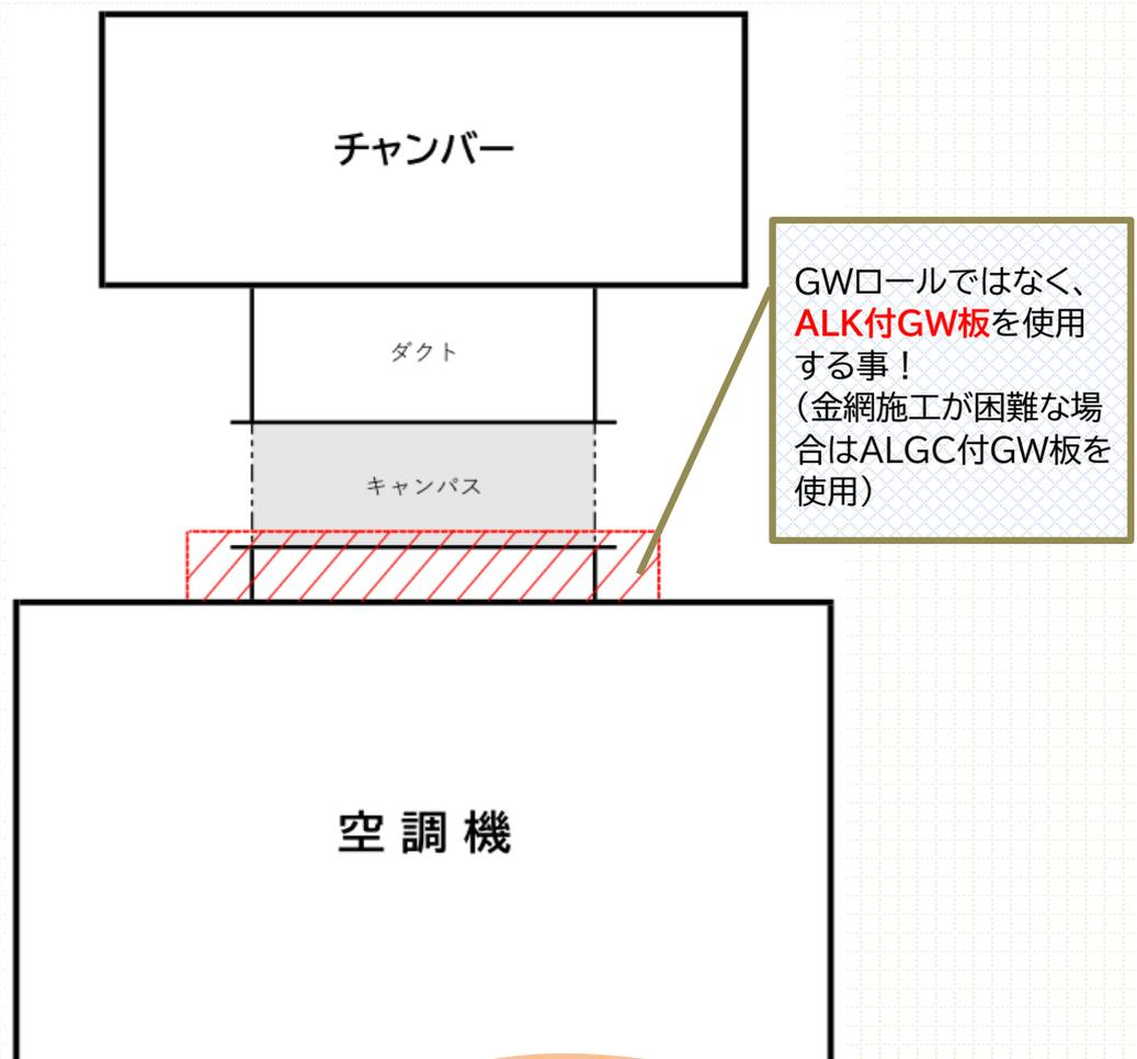
・空調機接続部のダクトに関しては、GWロールを使用すると隙間ができる可能性が高い為、結露の可能性が発生します。現場での指摘事項としても多く上がってくる部分です。
